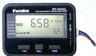
電圧表示と容量を表示できます
